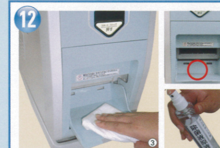
取り出し口も同様にスプレーし、ふき取ります。※以上で本体内部の保守作業は終わりです。
