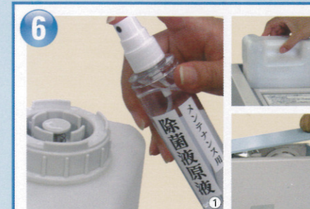
給水タンクの内面、外面、キャップ等を洗浄し、④と同じように原液をスプレーします。
