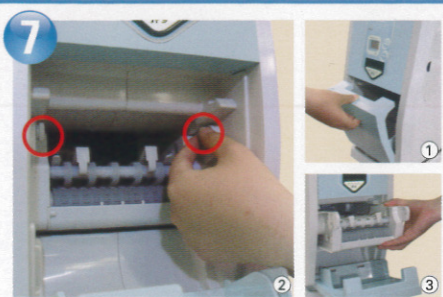
②固定ねじを外して、③ベルトコンベアを取り外します。
