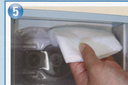
給水タンク収納部がきれいになるように側面などもふき取ります。
