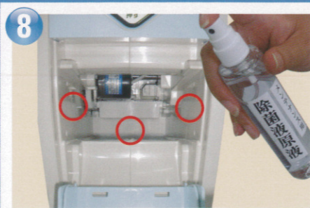
コンベア収納部(赤丸部分)に④と同じようにスプレーします。
