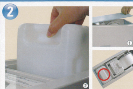
①上カバーを開け、②給水タンクを取り出します。
